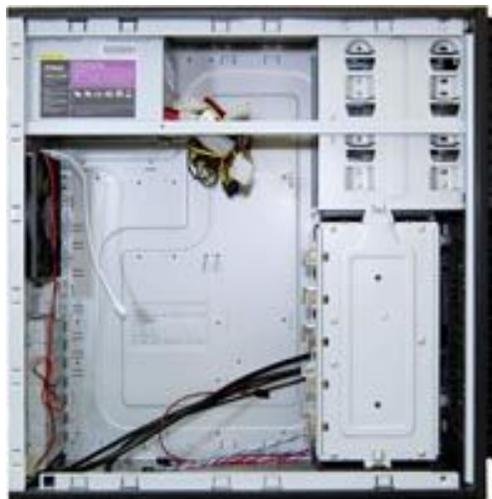
電源搭載モデルの「NSK6500」には、高効率で信頼できる430W ATX12V v2.01電源(アクティブPFC)を搭載しています。クリーンで環境にやさしく、高効率な性能を持ち、最大25%の電源消費低減を実現しています。また各種保護機能、OPP(過電力保護)、OVP(過電圧保護)、不足電圧保護機能(UVP)、短絡保護機能(SCP)を備えています。
